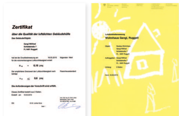
Abb. 6: Ein Blower-Door-Test in einem Passivhaus gebaut mit KLH®-Massivholzplatten. Mit Hilfe eines hervorragenden Luftdichtheitskonzeptes konnte ein n_{50} -Wert von 0,15 \text{ h}^{-1} realisiert werden [mit freundlicher Unterstützung durch Eberle • d e n k f a b r i k • Dornbirn, Österreich]
