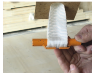
3. Bolzen mit der Sicherungsklammer nach unten einsetzen und entsprechend situieren
