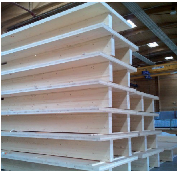
Fertige Rippenelemente, bereit für den Transport
