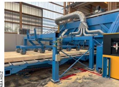
▲ Produktion der tragenden Innenwände aus KLH-Massivholz
