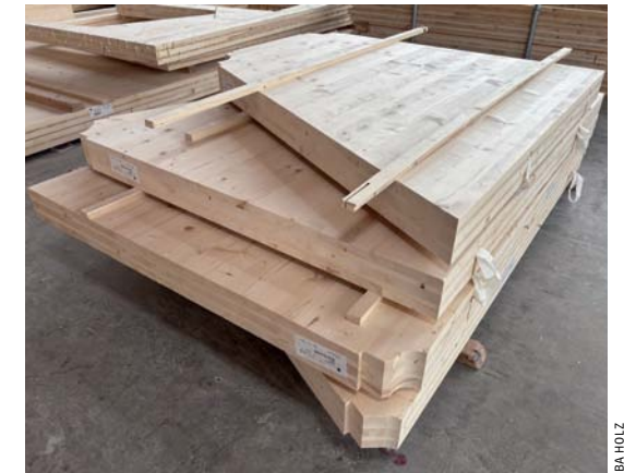
▲ Bereit zum Abtransport: Lagerung der fertigen Wandteile
