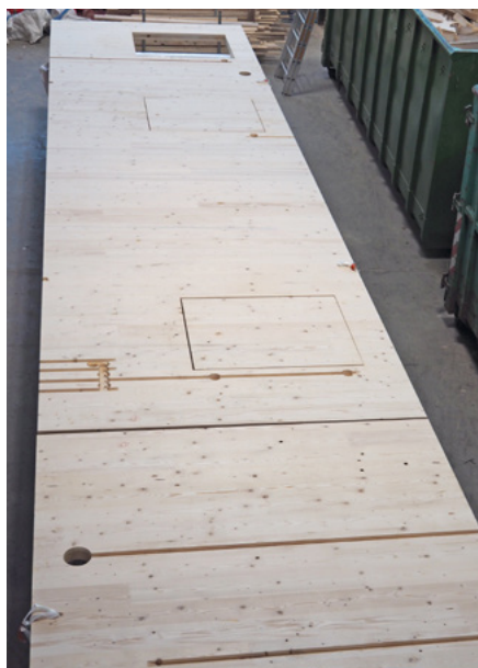
So sehen die typisch abgebundenen Platten aus – mit Fräsungen und Fensterausschnitten
