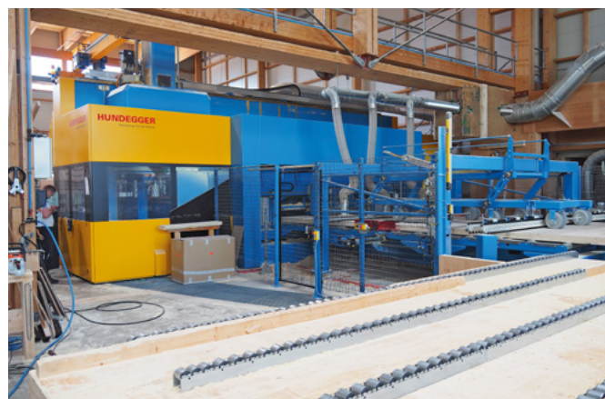
Erledigt die Bearbeitungen von oben und unten in einer Aufspannung: die PBA Drive von Hundegger.
